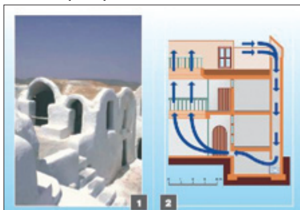
Figure 11 : Tours à vent dans le Sud Tunisien et principe de fonctionnement
