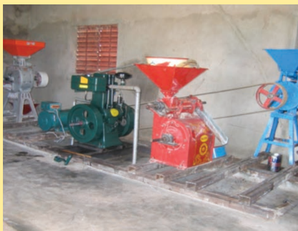
Image d'une PTFM standard avec moteur diésel, décortiqueuse de riz, moulin à céréales, alternateur et moulin à légumineuse
