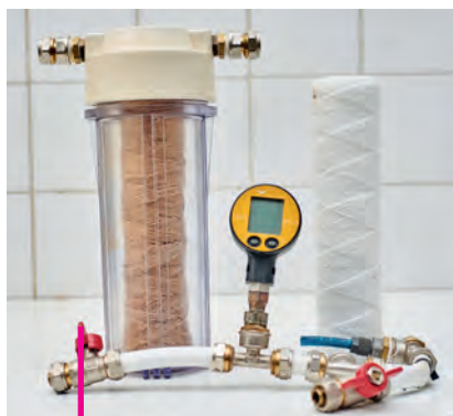
Filtre à eau à base de fibres de pseudo tronc de bananier
